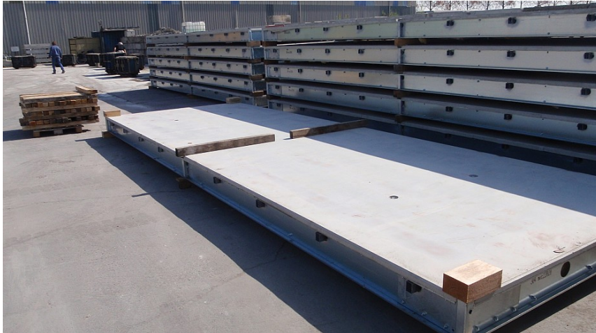
Afbeelding 4.10 Betonnen prefab elementen die gebruikt worden als rij- en parkeerdek (Carparks, 2019)
